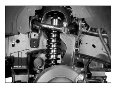
FINISHED INSTALL ON 6" FABTECH SYSTEM
